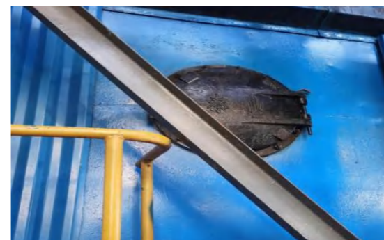
锅炉炉门改造前(卡扣式)
